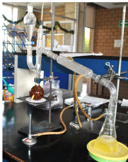
Equipo de destilación por arrastre de vapor directo
