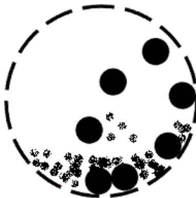
Fig.3.3. Molino de bolas. Tomado de: https://es.wikipedia.org/wiki/Molino_de_bolas
