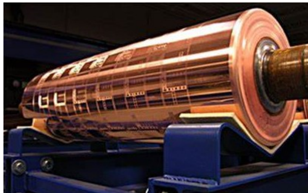
Rodillo de cobre grabado a distintas profundidades.
