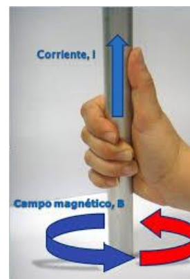
Figura 21. Determinación de la dirección de las líneas de flujo magnético.
